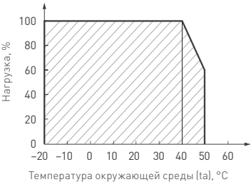
Рис. 4. Максимальная допустимая нагрузка, % от температуры окружающей среды
